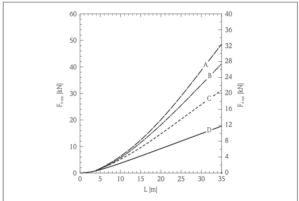
图 5 张力负载与料位 (L) 关系曲线图；6 mm (0.24 in) 和 4 mm (0.16 in) 缆式探头，石英砂料仓；光滑金属仓壁
