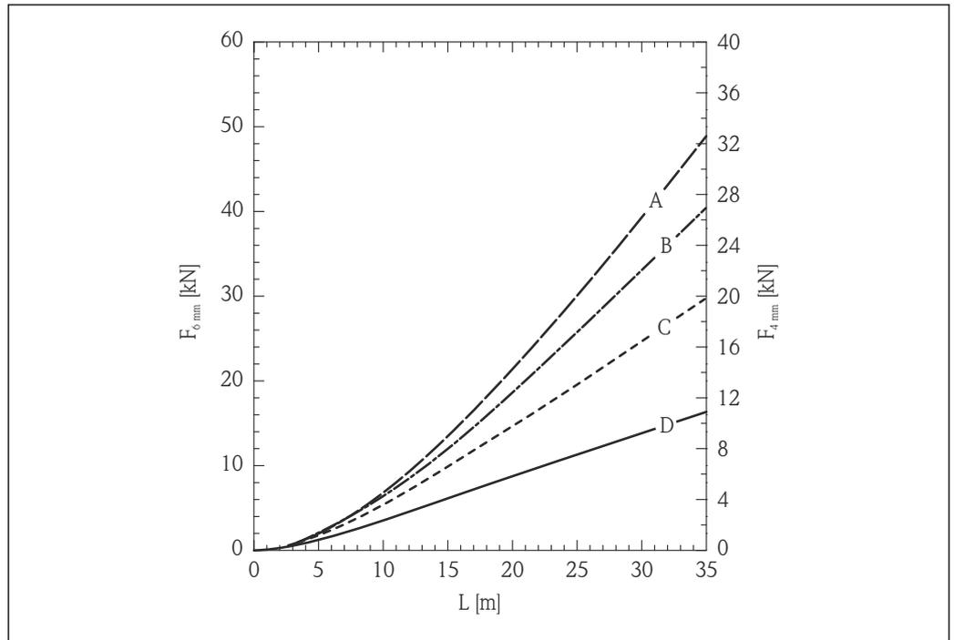
图 8 张力负载与料位 (L) 关系曲线图; 6 mm (0.24 in) 和 4 mm (0.16 in) 缆式探头, 水泥料仓; 光滑金属仓壁
