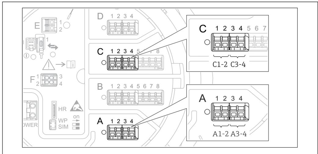
图 59 数字量输入/输出模块的可能安装位置 (示例) ; 订货号确定数字量输入模块的数量和位置 → 图 38。
