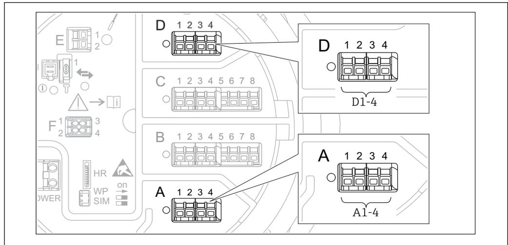
图 86 “Modbus”、“V1”或“WM550”模块名称实例；取决于设备型号，上述模块可以安装在插槽 B 或插槽 C 中。
