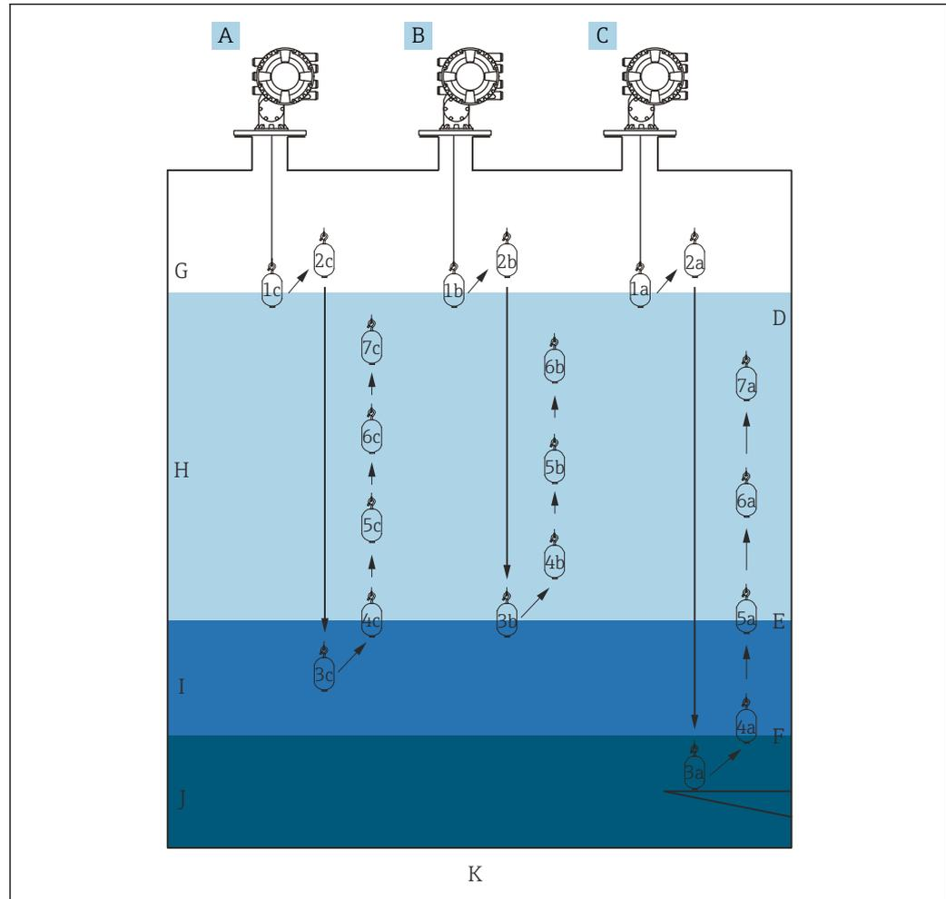
图 48 密度梯度概述 (1a、2a、3a...显示浮子移动顺序) 示意图
