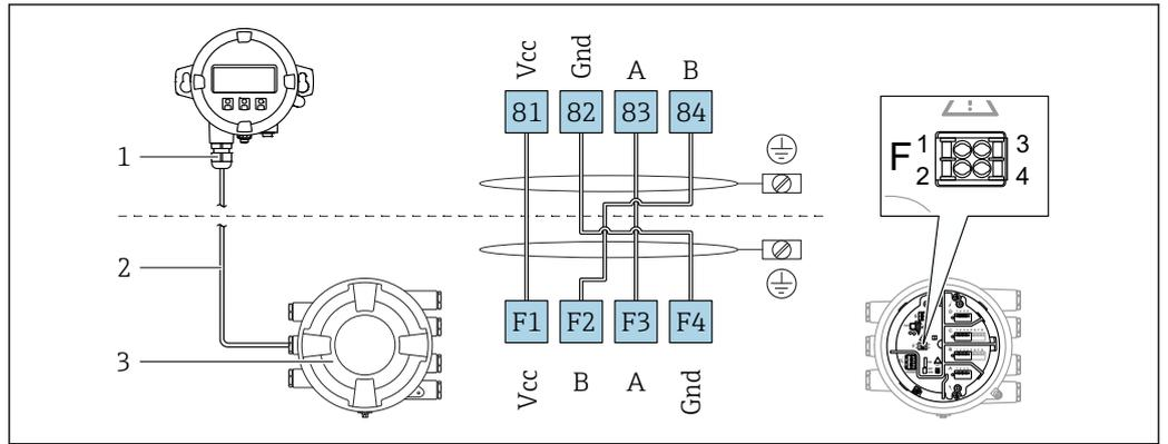
图 15 分离型显示与操作单元 DKX001 连接至罐旁指示仪 (NMR8x、NMS8x 或 NRF8x)
