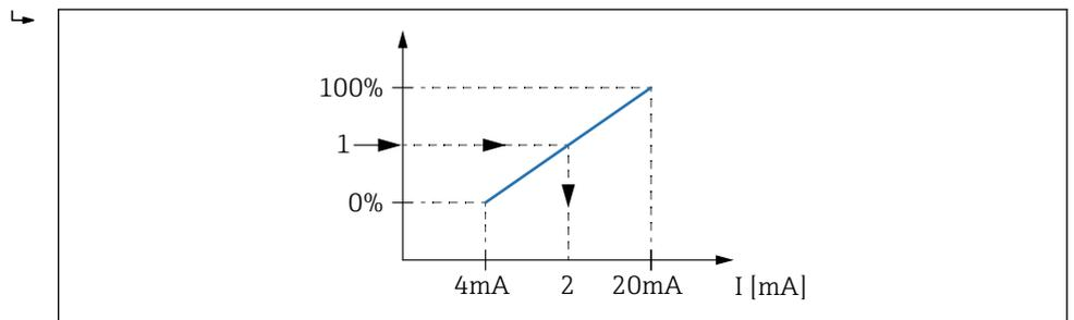
图 63 按输出电流调整罐体参数
