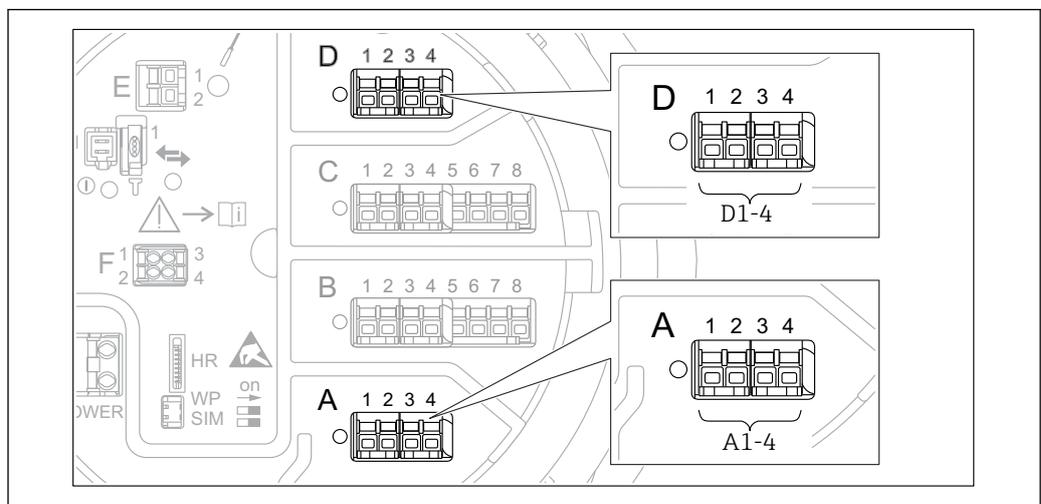
图 67 WM550 模块的可能安装位置（实例）；取决于设备型号，上述模块还可以安装在插槽 B 或 C 中 → 图 38。
