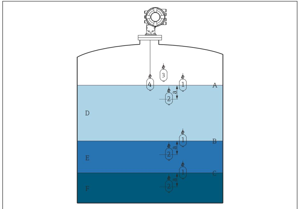
图 47 单点密度（数字显示浮子的移动顺序）示意图
