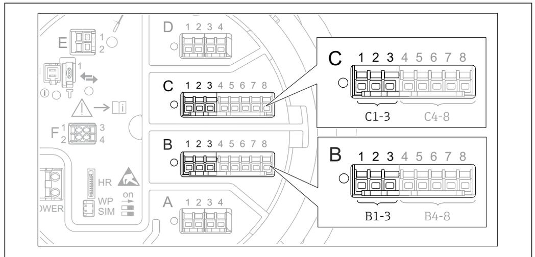
图 62 用作 4...20 mA 输出的模拟量输入/输出模块的可能安装位置。仪表订货号确定当前使用模块 → 图 38。
