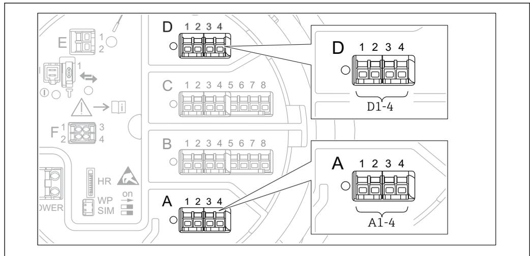
图 16 “Modbus”、“V1”或“WM550”模块名称实例；取决于设备型号，上述模块可以安装在插槽 B 或插槽 C 中。
