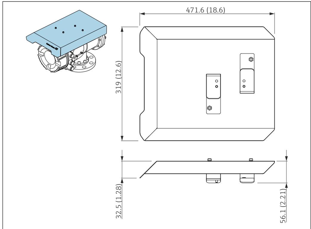
图 72 防护罩的外形尺寸示意图；单位：mm (in)
