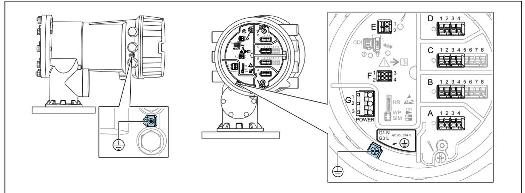
图 13 端子接线腔（典型实例）和接地端子示意图
