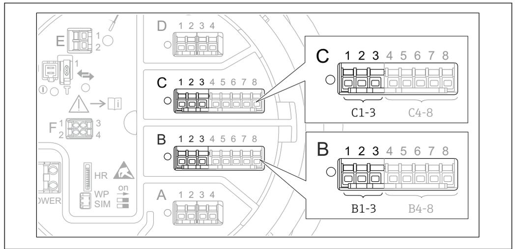
图 82 “Analog I/O” 子菜单的接线端子（分别为“B1-3”或“C1-3”）
