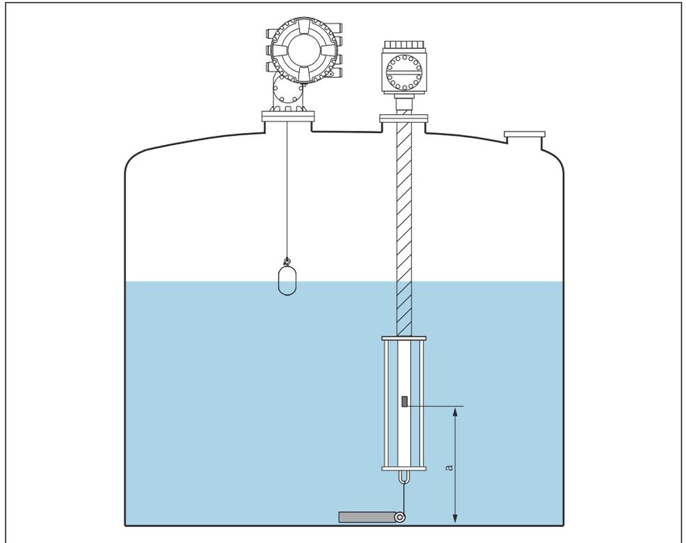
图 53 Prothermo NMT53x: 罐底测温元件位置
