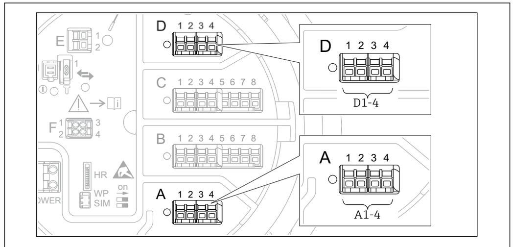
图 65 Modbus 模块的可能安装位置示例；取决于仪表型号，上述模块可以安装在插槽 B 或 C 中 → 图 38。
