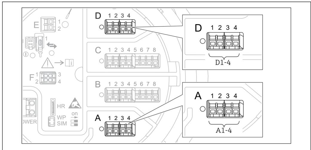
图 66 V1 模块的可能安装位置示例；取决于仪表型号，上述模块可以安装在插槽 B 或 C 中 → 图 38。
