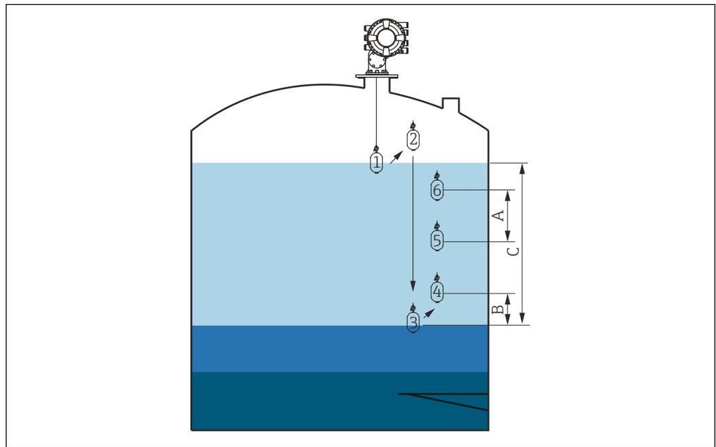
图 50 界面梯度位移（数字显示浮子的移动顺序）示意图
