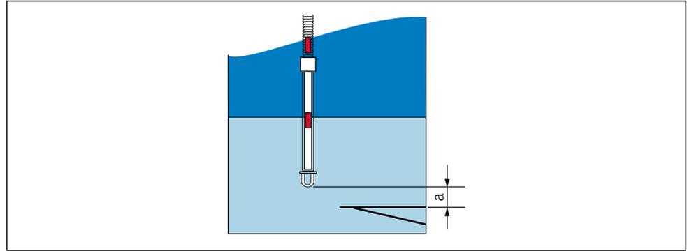
图 54 Prothermo NMT8x: 探头物理端与零点位置之间的距离
