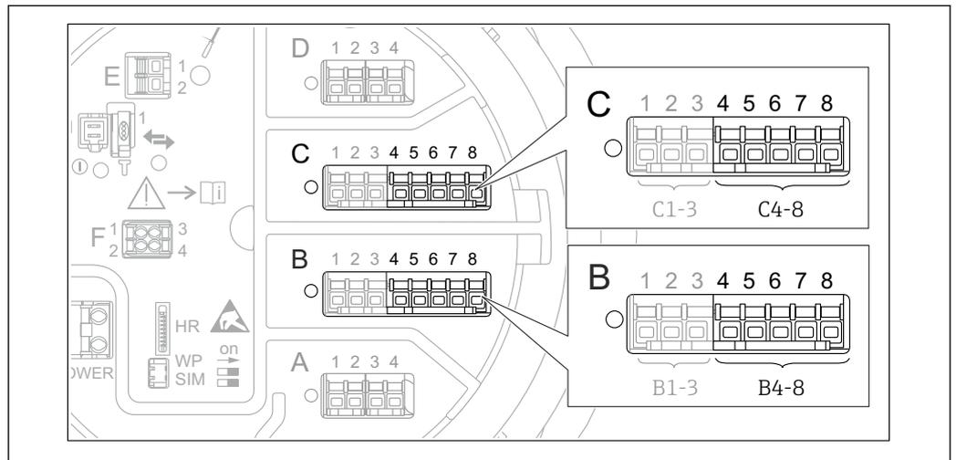
图 81 “Analog IP” 子菜单的接线端子 (分别为“B4-8”或“C4-8”)
