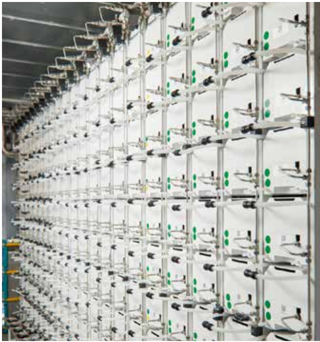
模块化 AEM 电解槽，允许串联使用，提高生产效率
